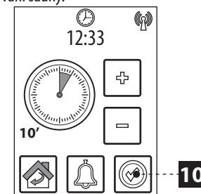
Pomocí tlačítek + a - je možné měnit délku trvání sauny.
